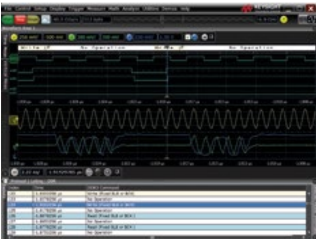
Декодирование протокола DDR3 и запуск по команде записи.
