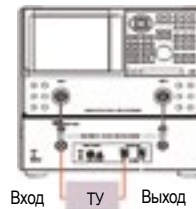
Рисунок 5 - Типовая схема измерения передатчика несимметричного сигнала
