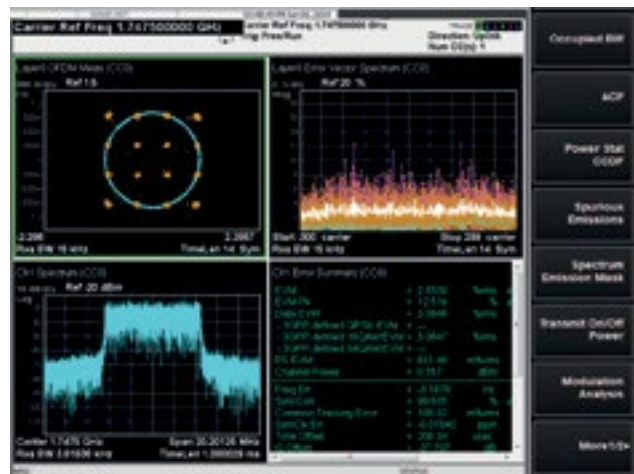
Процесс проверки качества модуляции передатчика LTE
